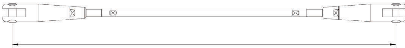
Tige filetée, pas à droite/pas à gauche, AISI 316
